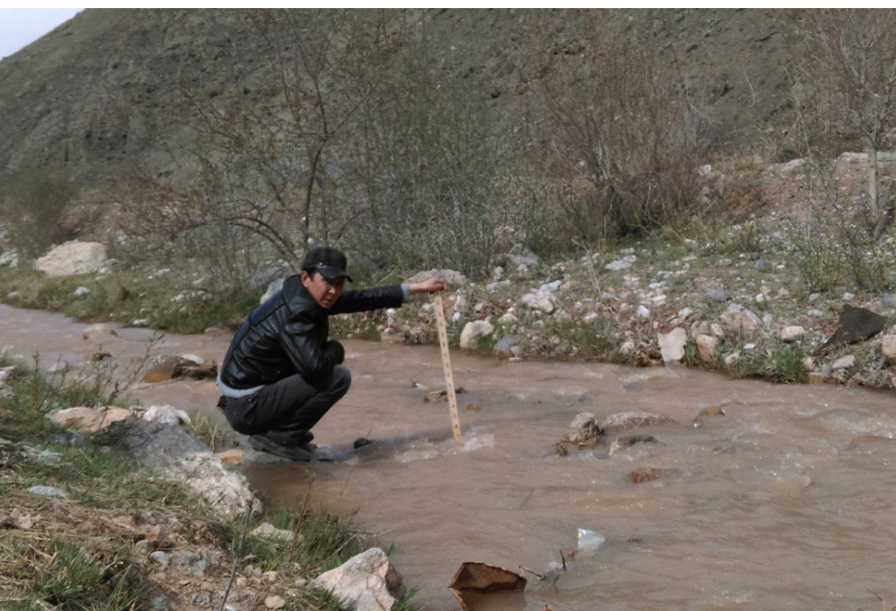
Рис. 5.2. Измерение глубины воды с помощью измерителя-рейки
