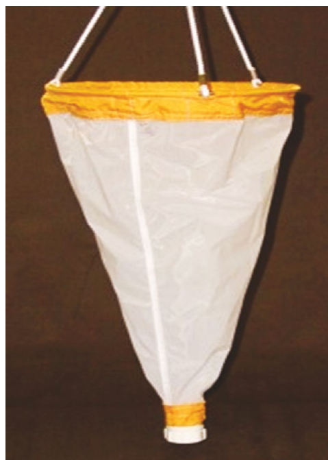
Рис.3.3. Планктонная сеть (сетяной конус)
