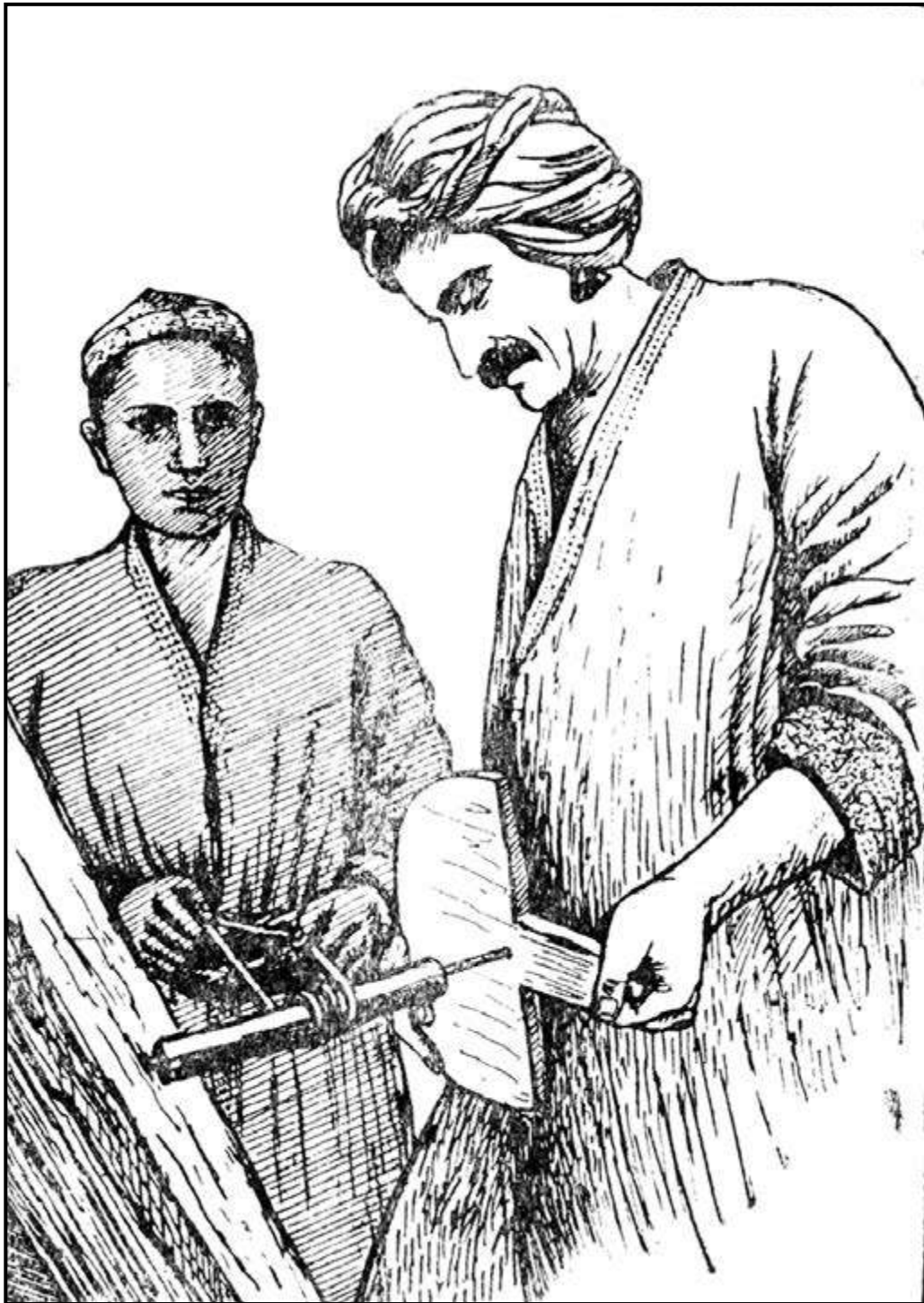
Рис. 30. Просверливание буром «бармай» отверстия в деревянной лопате (Хуф).
