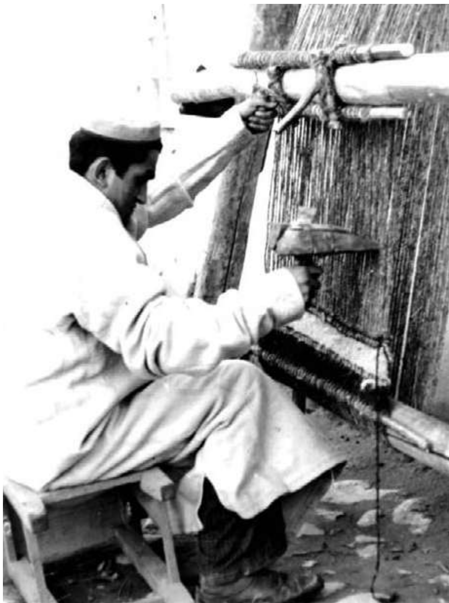
Рис. 79. Прибивание нитей основы бердом.
