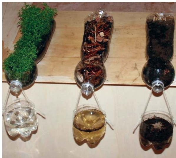
2.12. сүрөт. Сууну органикалык материалдар менен чыпкалоо
