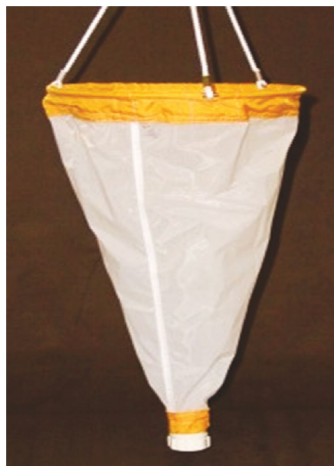
3.3. сүрөт. Планктон тору (конус тор)
